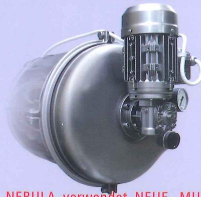
◆ NEBULA verwendet NEUE, MULTI-PROGRESSIVE SYSTEME FÜR FILTRIERUNG UND REINIGUNG DES LÖSUNGSMITTELS: System zur Reinigung des Lösungsmittels "mit unabhängigem, kontinuierlichem Fluß" und Filtrierungsgerät mit vergrößerten Kartuschenfiltern. (NEBULA "HFC" und "HFD"). Innovatives und fortgeschrittenes "NO FLEX" ULTRA MICRON Filtrierungssystem zu einer völligen Reinigung des Lösungsmittels. (NEBULA "HFT" und "HFD").
